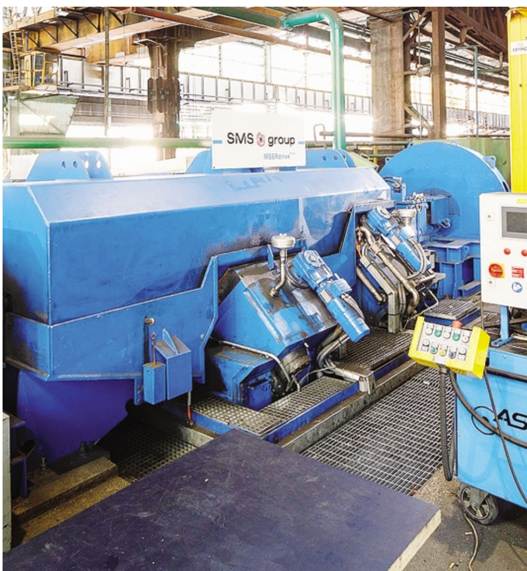
Il nuovo calibratore installato al Caleotto
