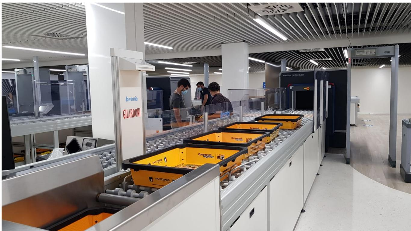
Brevia è un rivoluzionario sistema touchless di gestione dei bagagli a mano integralmente automatizzato, che consente la sterilizzazione delle vaschette utilizzate negli aeroporti tramite l'impiego della tecnologia UV-C. Lo scalo milanese di Linate l'ha già adottato e messo in funzione.
