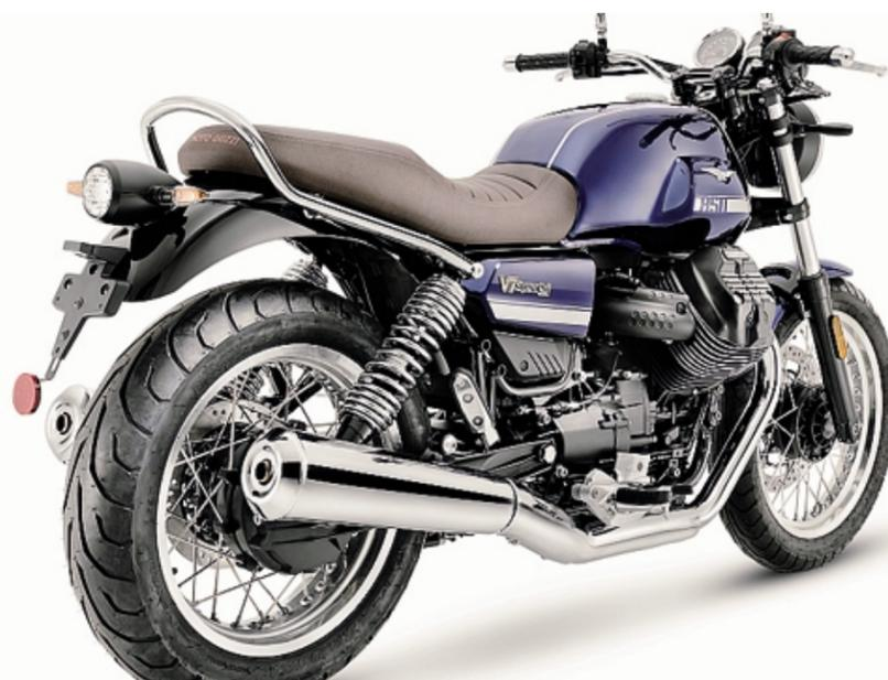
La nuova V7 versione Special monta un motore grintoso da 850 cc e 65 cavalli
