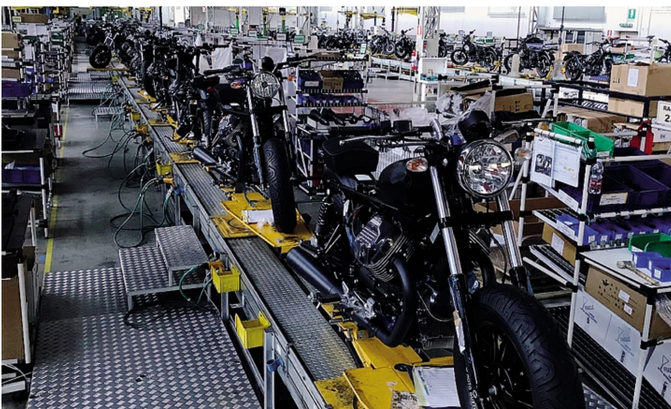
Una linea di montaggio nello stabilimento Guzzi di via Parodi a Mandello
